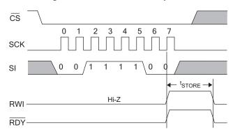
Figure 29. Software RECALL Cycle<sup>[13]</sup>
